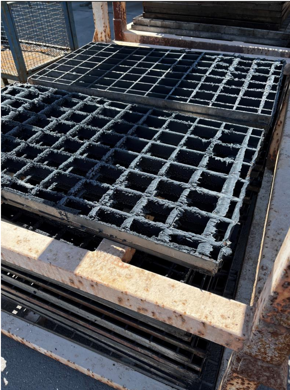
Figur 5 Metallgods med en tjock beläggning av lack som ska brännas bort i pyrolysugnen.
