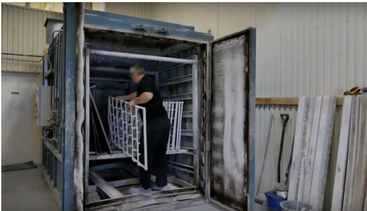
Figur 6 Pyrolysugnen lastas med metallgods.
